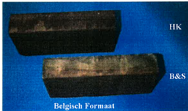
Figuur 16: Geperste stenen, Belgisch formaat (220 x 105 mm) van humusrijke klei (HK) en bouw & sloopafval (B&S)
