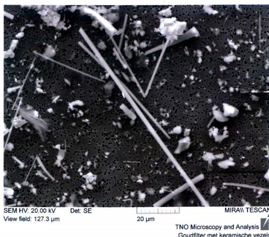
Foto 1: SEM-opname keramische vezel
